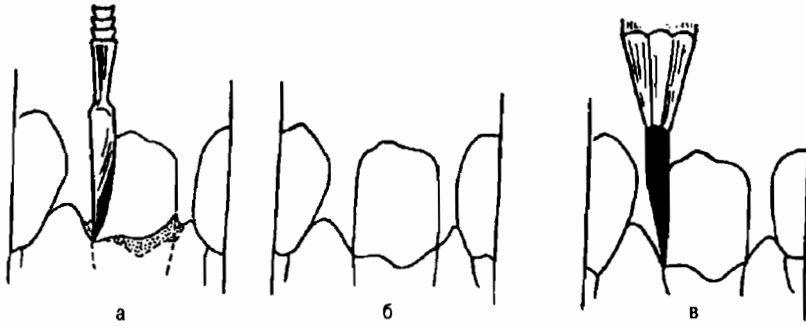
Рис. 164. Подготовка придесневой части гипсового зуба для изготовления штампованной коронки: а — гравировка шейки зуба скальпелем; б — вид опорного зуба с четко ограниченным контуром шейки; в — обозначение шейки химическим карандашом.
